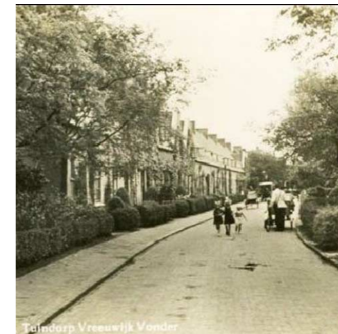
overall hagen als erfafscinding, vaak maar 0,6 m hoog aan de voorkant en 1,2 m achter
